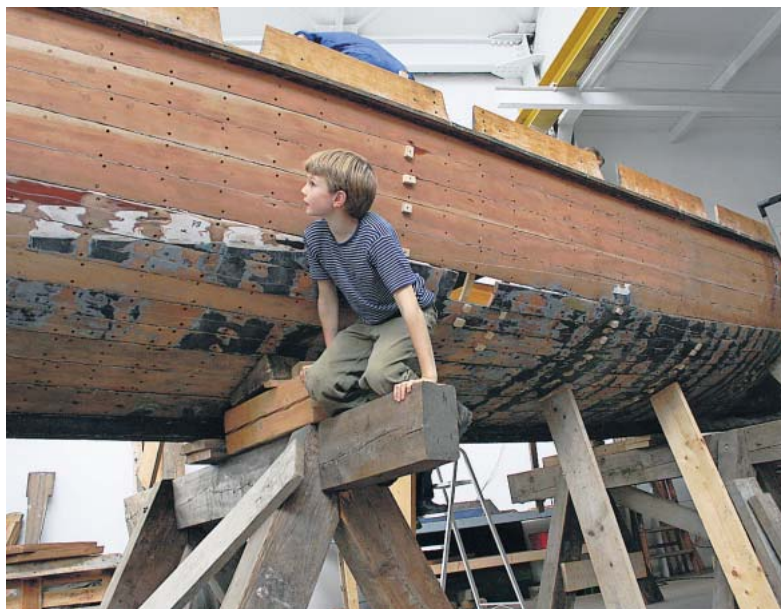
Junge Leute, altes Handwerk: Klas Klauberg (links) bereitet mit den Kutterkindern den Einbau eines neuen gedämpften Spants vor.
