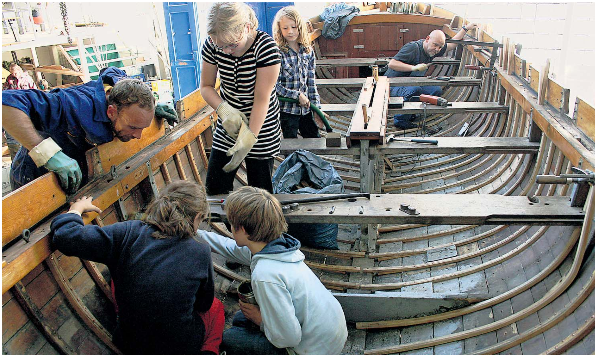
Junge Leute, altes Handwerk: Klas Klauberg (links) bereitet mit den Kutterkindern den Einbau eines neuen gedämpften Spants vor.
